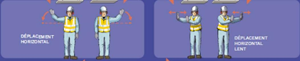
POUR LES MOUVEMENTS HORIZONTAUX DE L'APPAREIL DE LEVAGE
