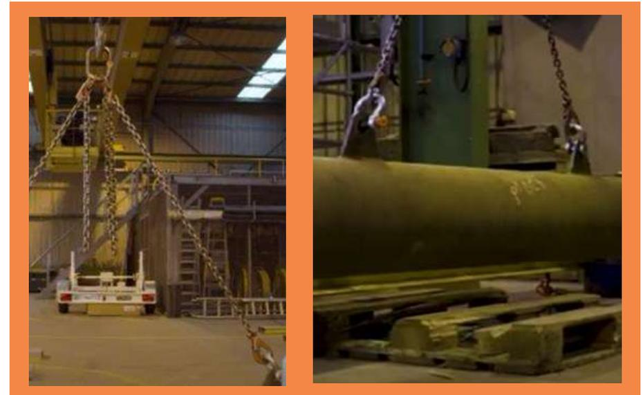
Un crochet avec une charge ou en mouvement (même sans charge), ou avec des élingues sous tension est considéré comme une charge
