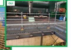
Une sécurisation continue d'une zone de danger doit être disposée à une distance suffisante du danger, déterminée par l'analyse de risques. L'accès ne peut être possible qu'en utilisant un outil ou une clé.
