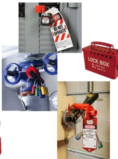
La consignation est une procédure de mise en sécurité d'une installation. Elle vise à neutraliser les sources d'énergie pendant une opération de maintenance ou de réparation d'une machine. Les réparations s'effectuent alors en toute sécurité, sans que les équipements ne se remettent en marche.
