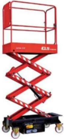
L'utilisateur de la PEMP doit porter un équipement antichute (harnais, longe de retenue, crochet) et s'accrocher sur le point d'ancrage du panier de la PEMP
